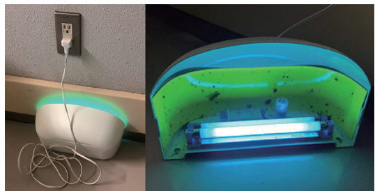
図8. UV捕虫器。左：設置状況の例、右：捕虫器の内部。フェロモントラップで上手く捕獲できない環境や、既に発生している場合に有効。UVランプからの直射光を向けるのではなく、反射光で誘引されるようにして設置する。他の照明器具が点灯し、明るさがある部屋では捕虫効率が低下する（真っ暗な室内では効果的）。図書や図画、紙資料などの博物館資料、壁面、床面、家具、什器等が変色・退色する可能性があるため、資料の周囲では用いず、また常設は避けた方がよい。
