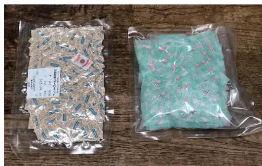
図6. 脱酸素剤（左）、酸素検知剤（右）。脱酸素剤を使った低酸素処理の際には必ず酸素検知剤を同梱して用いる。脱酸素剤と酸素検知剤は空気中で反応するので、低酸素処理時だけでなく、薬剤の保管時にも酸素を通さないガスバリア性の高い袋を用いる必要がある。
