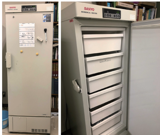
図2. 冷凍殺虫処理用の冷凍庫。左：扉を閉じた状態、右：扉を開いた状態。-30℃程度まで設定できるメディカルフリーザーと呼ばれる冷凍庫。専用トレーの大きさが、標本を収めるのにちょうどよいことや、霜がつきにくく、霜取りが容易なことなどの要件で機種選定するとよい。使用時は、扉の表面に掲示したホワイトボードに、内部トレーごとの内容物・実施予定期間・作業者名などを書き込む。
