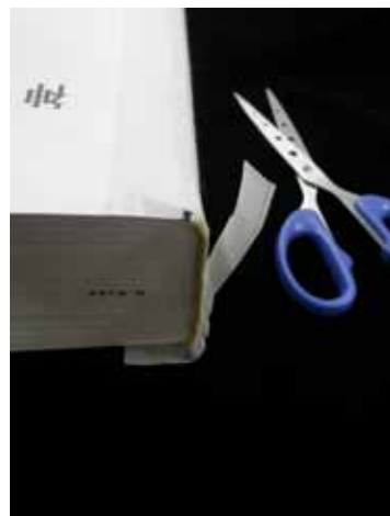
図 11. はみ出した寒冷紗を切る。
